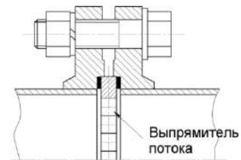
Рисунок 2.8 - Схема монтажа выпрямителя потока
